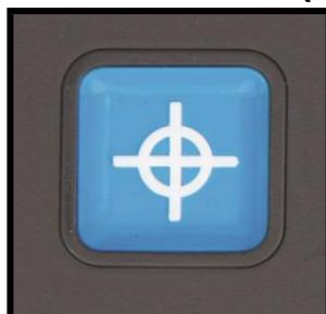
Pressione o botão azul quadrado durante três segundos para ativar um ponteiro luminoso vermelho no tabuleiro de leitura. O ponteiro ajuda-o a localizar o ponto para onde a câmara está a apontar. Por exemplo, ao escrever, coloque a sua caneta no ponto vermelho e a caneta aparecerá no centro do ecrã. Pressione novamente este botão para desativar o ponteiro. Após 30 segundos, o ponteiro desativa-se automaticamente.
