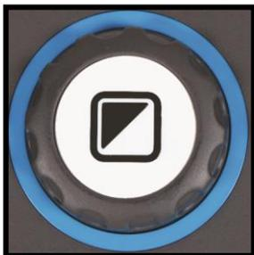
Pressione o botão branco central durante quarto segundos para desligar a iluminação do objeto. Por vezes pode ser preciso desligar a iluminação para evitar reflexos de luz. Pressione novamente o botão durante quarto segundos para voltar a ligar a iluminação. Se pressionar o botão brevemente, irá mudar para o próximo modo de leitura, e as luzes ligarão automaticamente.
